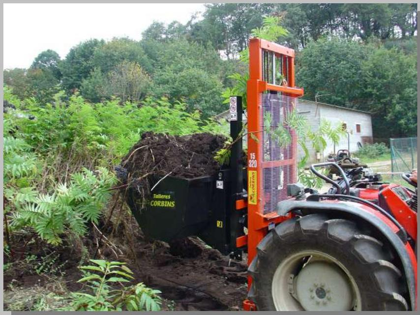
**ES** Pala adaptable a nuestros elevadores, al igual que a carretillas elevadoras. Esta indicada para el manejo de productos al detalle, cereales, aceitunas, abonos... Equipada de serie de enganche/desenganche rápido y tubos de conexión. Varias medidas: 1'50 mt., 1'80 mt., 2'00 mt.
